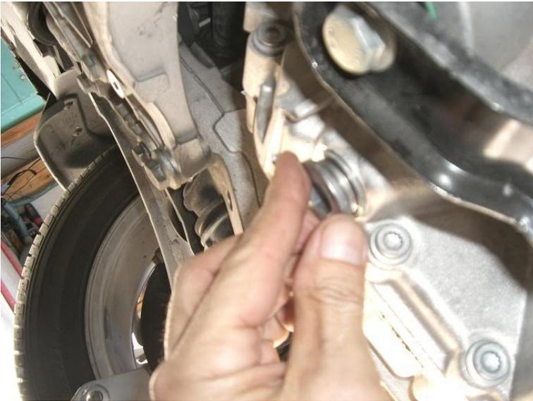
Per far drenare tutto l'olio dovete rimuovere la cartuccia interna con una chiave esagonale da 8 millimetri. A questo punto l'olio del dsg uscirà completamente. Dovreste trovarvi fuori Circa 5 litri di olio.
