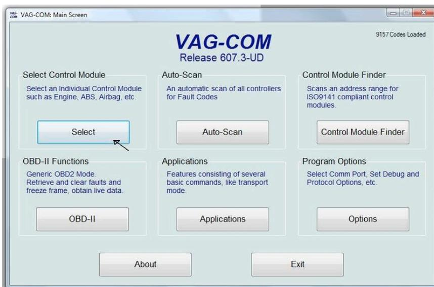
Selezionare la scheda di controllo del modulo schermo, selezionare 02 - Trasmissione automatica
