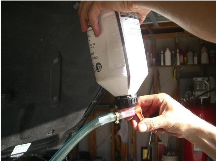
Assicurarsi che la trasmissione DSG sia riempita con 5,5 litri di olio. Per cambiare la bottiglie dovete semplicemente chiudere la valvola, agganciare una nuova bottiglia, e riaprire la valvola.
