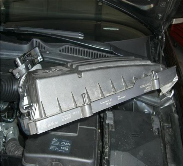
Una volta smontata la scatola filtro sarete in grado di vedere il tappo del filtro del dsg
