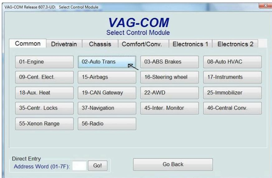
Selezionare Misura Blocchi. Selezionare il gruppo **019**. Guarda il ATF (Trasmissione automatica dei fluidi) Temperatura campo.
